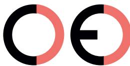
Marca CE falsa (demasiado separados)
